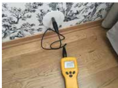
Hulltaking fra soverom 2. Relativ luftfuktighet 20%.
